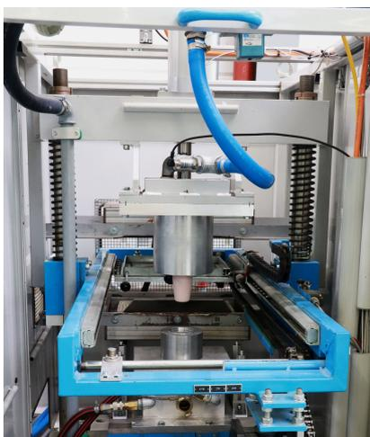
**Von einer solchen Thermoformmaschine** wird der dünne Content- in den stabilen System-Layer eingebracht – ein schneller und mechanisch einfacher Prozess. Foto: Fraunhofer LBF
